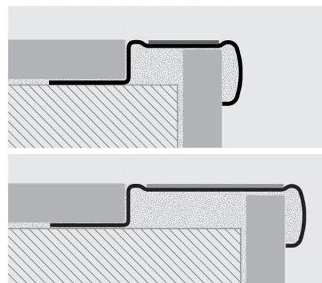
1. Scegliere PROSTAIR GRIP ACC in funzione dello spessore della pavimentazione.
