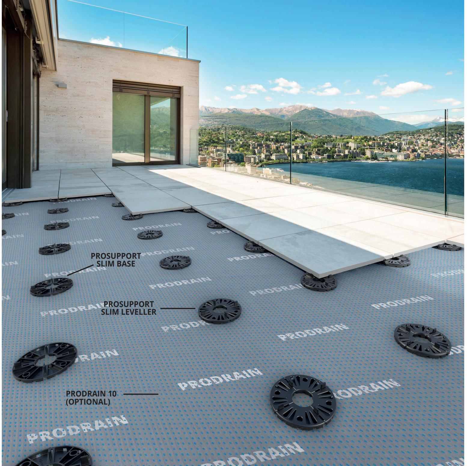
I **SUPPORTI** e **LIVELLATORI** sono ideati per la realizzazione di pavimentazioni esterne sopraelevate. I supporti, in polietilene, hanno una altezza di 15 mm. I livellatori in gomma, di spessore 3 mm, possono essere applicati sui supporti sino ad un massimo di 2. I **SUPPORTI** e **LIVELLATORI** sono ideati per aree esterne, terrazze, bordi piscina e passaggi pedonali.
