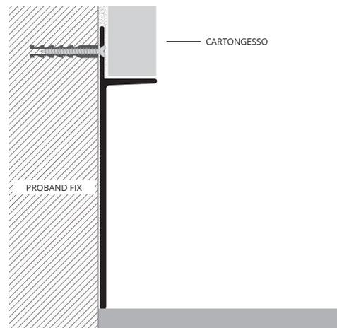
1. Fissare a parete con tasselli "PROSKIRTING INS" 2. Posare il cartongesso avendo cura di allinearne inferiormente con la sezione orizzontale 3. Applicare la finitura desiderata 4. Rimuovere immediatamente residui di prodotto dalla superficie del profilo.
