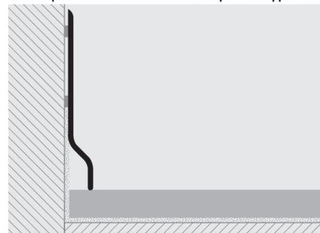
1. Выберите плинтус требуемого цвета. 2. Положите плинтус, используя быстросохнущий акриловый силикон, мастику, «бостик», подходящие для наклеивания ПВХ на строительный раствор, штукатурку, разнообразных стен, и т.д. или зафиксируйте с помощью болтов или гвоздями.
