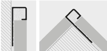
1. Choisir le PROJOLLY SQUARE d'une hauteur correspondant à l'épaisseur du support. 2. Appliquer la colle dans la partie adaptée du profil. 3. Poser et aligner le profil, déjà coupé à la longueur nécessaire, en appuyant l'ailette perforée sur la colle. 4. Poser les carreaux de façon que la partie supérieure du profil soit alignée. 5. Remplir complètement de colle la zone de contact entre le profil et le carreau pour éviter les infiltrations d'eau.
