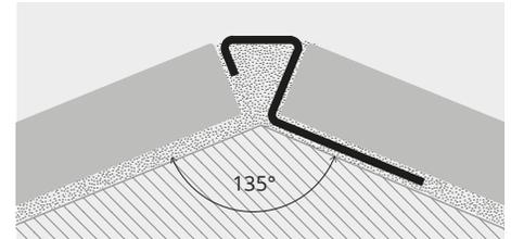
1. Elegir "PROJOLLY ANGLE 135" en función de el espesor de la baldosa y de el acabado requerido.
