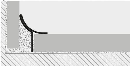
1. Escoger el perfil "PROINTER KL ACC" en función de el acabado requerido. 2. Cortar "PROINTER KL ACC" a la medida necesaria. 3. Aplicar la silicona a lo largo del enlace pared - suelo. 4. Empujar la punta de la flecha del perfil "PROINTER KL ACC" en la silicona y hacerlo adherir a la pared y al suelo.
