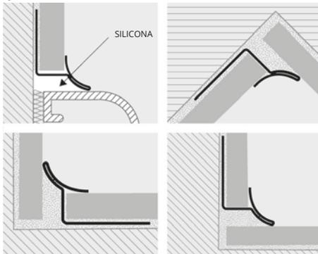
1. Elegir "PROINTER AC" en función de el espesor de la baldosa y de el acabado requerido. 2. Cortar "PROINTER AC" a la medida necesaria y aplicar el cemento cola al soporte donde se tendrá que colocar el perfil. 3. Presionar la aleta del perfil "PROINTER AC" en el cemento cola. 4. Colocar la baldosa alineando la misma al perfil y dejando una junta de 2 mm entre perfil y baldosa. 5. Rejuntar entre baldosa y perfil para evitar que se filtre el agua.
