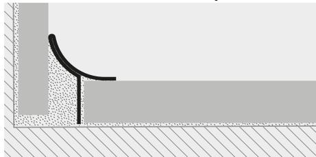
1. Choisir PROINTER KL dans la finition de surface voulue et couper de la longueur nécessaire. 2. Remplir complètement de silicone/colle/adhésif le vide entre deux revêtements ou entre le sol et le revêtement de la zone. 3. Encastrer le profil avec la jambe verticale à flèche immergée dans la silicone/colle/bi-adhésif.
