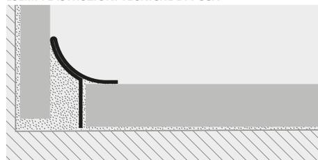
1. Scegliere "PROINTER KL ACC" in funzione della finitura desiderata. 2. Tagliare "PROINTER KL ACC" alla lunghezza desiderata. 3. Applicare il silicone lungo il raccordo parete - pavimento. 4. Premere la punta a freccia di "PROINTER KL ACC" nel silicone avendo cura di farlo aderire alla parete e al pavimento.
