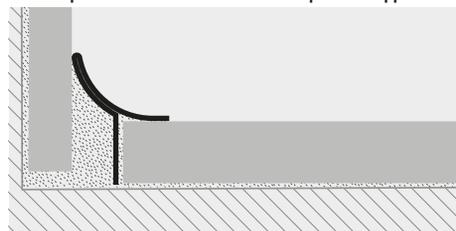
1. Выберите PROINTER KL требуемой лицевой отделки и отрезать по необходимой длине. 2. Полностью заполните силиконом/клеем/герметиком/мастикой пустоты между двумя облицовками или между полом и облицовкой зоны. 3. Ввести профиль с вертикальным выступом с прогибом введённым в силикон / клей / двустороннюю клейкую ленту.
