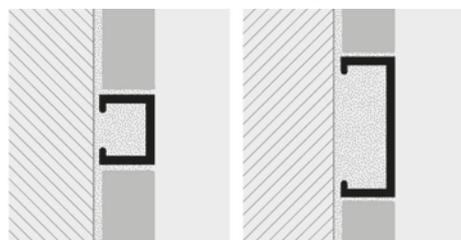
1. Choisir la finition superficielle. 2. Appliquer la colle dans la zone d'application du profil. 3. Appuyer et aligner le profil coupé à la longueur nécessaire. 4. Poser les carreaux/céramique ou étaler la résine en l'alignant de manière à ce que la partie supérieure du profil ferme hermétiquement.
