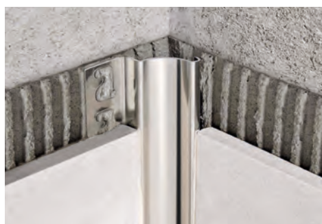
ACCIAIO INOX AISI 304/1.4301-V2A LUCIDO con pellicola protettiva - lungh. barre 2,7 ml - conf. 20 PZ - 54 ml - 10/10 mm
