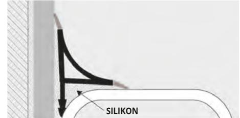
1. Je nach Höhe "PROBATH" auswählen. 2. "PROBATH" auf gewünschte Länge schneiden. 3. Säubern Sie die Auflagefläche von Ölen, Fetten und Schmutzigkeit. 4. Wenn die Auflagefläche sauber ist, Silikon auf die Rückseite des Profils auftragen und drücken ohne einschlagen für die Verlegung.
