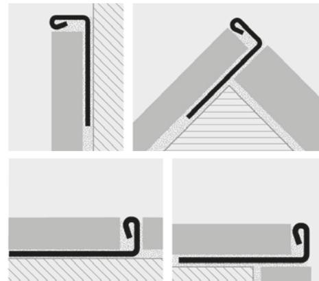
1. Scegliere PROTERMINAL in funzione dello spessore della piastrella e della finitura desiderata. 2. Tagliare PROTERMINAL alla lunghezza desiderata ed applicare l'adesivo sul supporto dove sarà posato il profilo. 3. Premere l'aletta di ancoraggio di PROTERMINAL nell'adesivo. 4. Posare le piastrelle avendo cura di allinearle al profilo e di lasciare una fuga di circa 2 mm. 5. Stuccare accuratamente le fughe tra profilo e piastrella onde evitare il ristagno di eventuale acqua.
