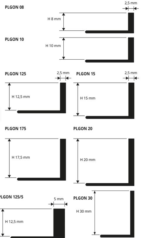
**PROLEVIGAL** ist ein Trennprofil aus Aluminium im Form von "L". Es ist geeignet als Trennprofil zwischen zwei verschiedene Böden oder als Dekorleiste für Verkleidung. Das Profile mit Stanze gibt eine optimale Verankerung unter dem Fußboden und auf glatte vertikale Wände, wenn verlegt kann man das Profil schleifen. **PROLEVIGAL** aus Aluminium ist geeignet in Bereiche mit hohen mechanischen und chemischen Belastungen.
