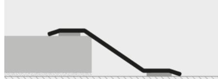
1. Выберите подходящий профиль и отрежьте его по необходимой длине. 2. Прочистите, промойте, обезжирьте твердую поверхность тщательно. 3. Удалите защитную пленку с kleящего средства. 4. Положите профиль правильно, применяя равномерное давление по всей поверхности, не используя молоток.
