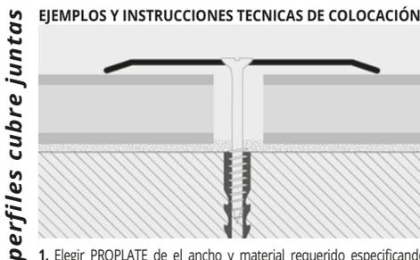
1. Elegir PROPLATE de el ancho y material requerido especificando si tiene que ser con agujeros o con adhesivo. 2. Cortar el perfil a la medida necesaria.
