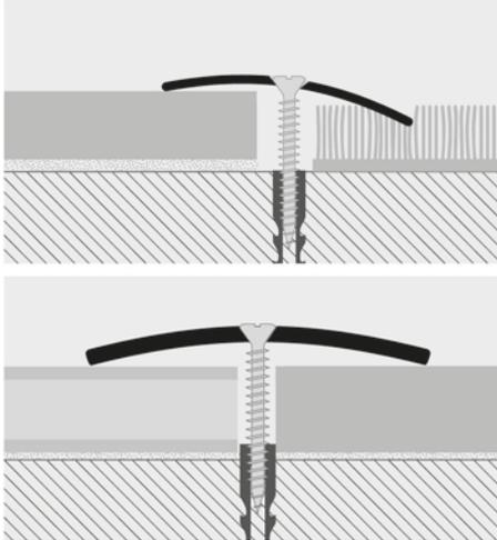
1. Je nach Breite "PROSOL 30-35-40" auswählen. 2. Das "PROSOL 30-35-40" auf gewünschte Länge schneiden. 3. Der Unterbau auf der Höhe der Löcher des Profils merken. 4. Der Unterbau mit einem Bohrer von 5 mm Durchmesser durchbohren und die Dübel von 5x25 mm stecken. 5. Das Profil auf die Löcher anbringen und zum Unterbau schrauben.
