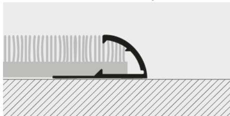
1. Couper le profilé à la longueur nécessaire. 2. Fixer le PROMOQUETTE au sol à l'aide de vis/clous ou d'adhésif double face/scotch. 3. Introduire la moquette dans le côté courbé du profilé en la tendant de manière appropriée. 4. Ecraser le profilé en pressant de manière uniforme jusqu'à ce que la moquette restant bien bloquée à l'intérieur.
