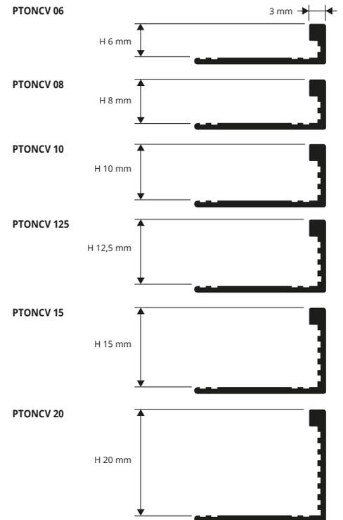
**PROTERMINAL CURVE** est une série de profilés, d'extrémité et de séparation, pouvant être façonnés et courbés, dotés d'un découpage particulier qui permet d'obtenir des formes géométriques et donc de créer des dessins décoratifs pour tous types d'exigences techniques et esthétiques, avec une surface de 3 mm de profilé polissable. Les profilés sont réalisés en aluminium naturels dans des différentes hauteurs (6 - 8 - 10 - 12,5 - 15 et 20 mm) en barres de 2,7 ml.
