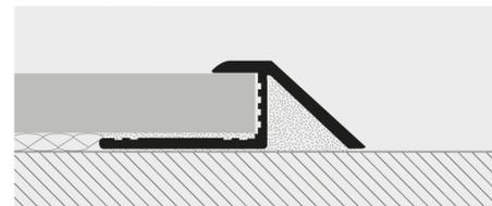
**PROSLIDER CURVE** sono una serie di profili curvabili / sagomabili di raccordo, con una speciale tranciatura deformabile che permette di realizzare e ottenere facilmente in opera forme geometriche particolari, consentendo di creare disegni decorativi a piacimento in funzione alle esigenze tecniche ed estetiche. Consigliato per raccordare pavimenti galleggianti in legno, in legno laminato melaminico e ceramica. Viene prodotto in Alluminio anodizzato in varie altezze, lung. 2,7ml.
