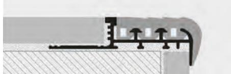
1. Elegir "PROSTAIR / PROSTEP" en función del espesor del pavimento y del color requerido.
