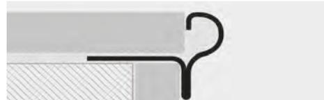
1. "PROSTYLE" gemäß der Bodenstärke auswählen. 2. Die Verkleidung auf der Setzstufe auflegen und den Kleber auf dem Auftritt anbringen, wo das Profil verlegt werden soll. 3. Das Profil auf der Trittstufe anbringen und dabei darauf achten, es auf der zuvor angebrachten Setzstufe aufzulegen. 4. Die Verkleidung auf die Trittstufe auflegen; dabei auf eine korrekte Ausrichtung mit dem Profil achten. 5. Die Fugen zwischen Profil und Fliese sorgfältig verfugen, damit sich kein Wasser ansammeln kann.
