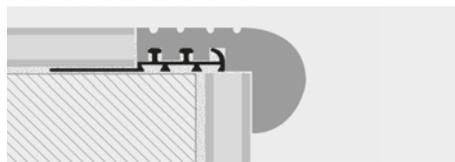
1. Scegliere PROSTAIR WOOD Z in funzione dello spessore del rivestimento.
