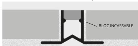
1. Choisir un joint de la couleur et de l'épaisseur du revêtement en calculant 0,5-1 mm de moins par rapport à ce dernier. Le joint ne doit en aucun cas dépasser.
