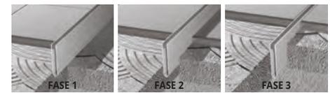
1. "ANSCHLUSSPROFIL FÜR MÖRTELVERLEGUNG" gemäß der Höhe und der gewünschten Farbe auswählen. 2. "ANSCHLUSSPROFIL FÜR MÖRTELVERLEGUNG" auf die gewünschte Länge zuschneiden. 3. Den Estrich mit der Kelle entlang des Fußbodenrandes schneiden. 4. Die Fuge im frischen Estrich positionieren, dabei darauf achten, dass sie mit der Oberfläche des Fußbodens ausgerichtet wird. 5. Den Estrich und den Fußboden verlegen.
