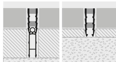
1. "DOPPELANSCHLUSSPROFIL FÜR MÖRTELVERLEGUNG" gemäß der gewünschten Farbe auswählen. 2. "DOPPELANSCHLUSSPROFIL FÜR MÖRTELVERLEGUNG" auf die gewünschte Länge zuschneiden. 3. Den Estrich mit der Kelle entlang des Fußbodenrandes schneiden. 4. Die Fuge im frischen Estrich positionieren, dabei darauf achten, dass sie mit der Oberfläche des Fußbodens ausgerichtet wird. 5. Den Estrich und den Fußboden verlegen.
