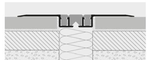
1. Elegir "PROEXPAN 115-130-190-210" en función de la junta existente y de los movimientos requeridos. 2. Cortar "PROEXPAN 115-130-190-210" a la medida necesaria. 3. Fijar las alas de aluminio al pavimento con resina epoxy de dos componentes
