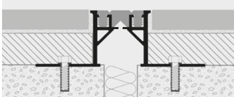
1. Choisir le joint de dilatation d'une hauteur correspondant à l'épaisseur du revêtement fini et de la fondation, en précisant la couleur de l'insert. 2. Fixer les ailettes latérales perforées à la fondation, parallèlement des deux côtés, tous les 30 cm environ, à l'aide de vis et de chevilles. 3. Réaliser la fondation au-dessus des ailettes perforées du joint de construction et/ou de dilatation en calculant l'épaisseur du revêtement définitif puis poser normalement.
