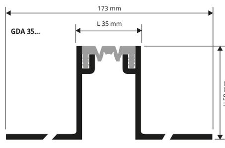
1. Choisir le joint de dilatation d'une hauteur correspondant à l'épaisseur du revêtement fini et de la fondation, en précisant la couleur de l'insert. 2. Fixer les ailettes latérales perforées à la fondation, parallèlement des deux côtés, tous les 30 cm environ, à l'aide de vis et de chevilles. 3. Réaliser la fondation au-dessus des ailettes perforées du joint de construction et/ou de dilatation en calculant l'épaisseur du revêtement définitif puis poser normalement.
