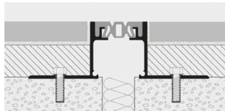
1. "GDA 55" gemäß der Farbe auswählen. 2. Die gelochten Seitenschenkel des Profils mit Dübeln in einem Abstand von ca. 30 cm an der Struktur befestigen. 3. Den Estrich herstellen und die Fliesen verlegen, dabei eine Fuge von circa 1 mm zwischen Profil und Fliese freilassen. Nach dem Verlegen muss die Fuge immer um 0,5 mm unter der Bodenoberfläche positioniert sein. 4. Die Fugen zwischen Profil und Fliesen vollständig mit Kit ausfüllen, damit kein Wasser in die Hohlräume eindringen kann.
