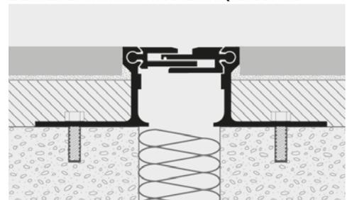
1. Choisir le joint de dilatation d'une hauteur correspondant à l'épaisseur du revêtement fini et de la fondation, en précisant la couleur de l'insert. 2. Fixer les ailettes latérales perforées à la fondation, parallèlement des deux côtés, tous les 30 cm environ, à l'aide de vis et de chevilles. 3. Réaliser la fondation au-dessus des ailettes perforées du joint de construction et/ou de dilatation en calculant l'épaisseur du revêtement définitif puis poser normalement.
