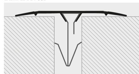
Les **PROPLATE FIX** sont une série de profilés couvre-joint plat permettant de couvrir les mouvements structuraux et de dilatation (retrait flexion-retrait compression) de deux structures portantes différentes.
