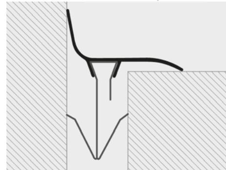
1. Choisir le profilé de la largeur et du matériel désirés. 2. Introduire tous les 50/75 cm (5 pièces pour un usage vertical - 10 pièces pour un usage horizontal) les clips de fixation dans la rainure prévue à cet effet. 3. Introduire le PROPLATE FIX, à la main en pressant de manière uniforme ou à l'aide d'un marteau en plastique, dans le vide existant de manière à créer un couvre-joint parfait. Suivre la même méthode pour la pose en angle.
