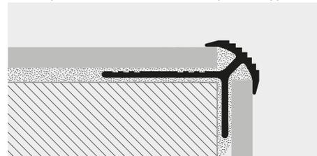
**PROSTAIR KL 20** это профиль для ступеней, технический и очень элегантный, придаёт эффект антискольжения, для тонкой керамической плитки и керамогранита/Laminat. Выполнен из анодированного алюминия с верхней рифленой частью, для увеличения эффекта антискольжения и с нижним вертикальным ребром, для закрытия выступа ступени. Должен использоваться в обязательном порядке в общественных помещениях для предотвращения несчастных случаев. Выпускается с высотой Н:4,5 мм.
