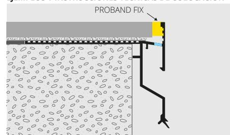
1. Elegir "PROTERRACE DRAIN DRIP" en función del espesor de la baldosa y del color requerido.
