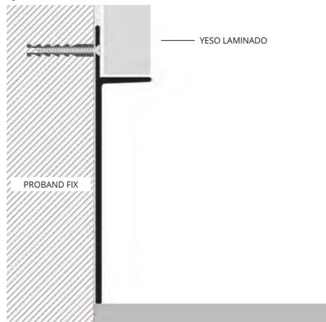
1. Fijar "PROSKIRTING INS" con tornillon a la pared 2. Colocar el cartón yeso y alinearlo inferiormente a la parte horizontal 3. Aplicar el acabado requerido 4. Quitar inmediatamente los residuos de producto de la superficie del perfil.
