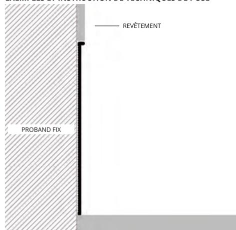
1. Fixer le PROSKIRTING LINE avec de la colle/silicone (sous le côté apparent) avant de réaliser le revêtement choisi, en calculant les hauteurs et les distances. 2. Effectuer la finition superficielle en alignant la partie inférieure avec le PROSKIRTING LINE. **IMPORTANT:** Faire très attention aux bords externes du Proskirting en aluminium. Ils doivent être protégé contre les agressions chimiques des colles dressantes/scellantées.
