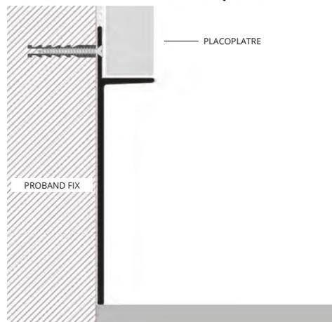
1. Fixer le PROSKIRTING INS avec des vis (côté sous enduit) et avec de la colle/silicone (sous le côté apparent) avant de poser le placoplâtre, en calculant les hauteurs et les distances. 2. Poser le placoplâtre en alignant la partie inférieure avec le PROSKIRTING INS. 3. Mastiquer et réaliser la finition superficielle définitive sur le placoplâtre.
