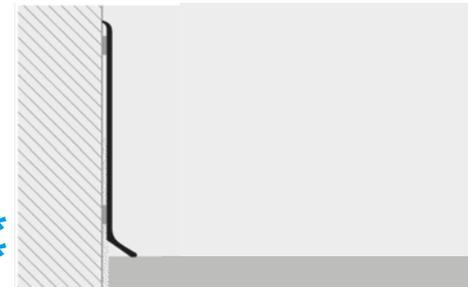
UTILICE PROBAND FIX PARA FIJAR EL PERFIL A LA PARED
