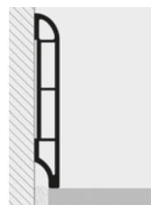
1. Choisir la plinthe de la couleur souhaitée. 2. La pose doit être effectuée en collant la plinthe directement au support à l'aide d'une colle appropriée ou de clous spéciaux
