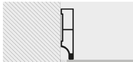
1. Choisir la plinthe de la couleur souhaitée. 2. La pose doit être effectuée en collant la plinthe directement au support à l'aide d'une colle appropriée ou de clous spéciaux
