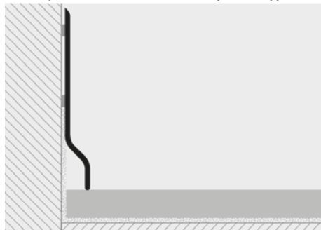
1. Выберите плинтус требуемого цвета. 2. Положите плинтус, используя быстросохнущий акриловый силикон, мастику, «бостик», подходящие для наклеивания ПВХ на строительный раствор, штукатурку, разнообразных стен, и т.д. или зафиксируйте с помощью болтов или гвоздями.
