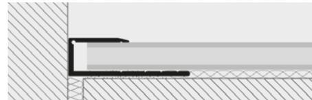
1. Wählen Sie TERMINAL auf der Grundlage der gewünschten Höhe und Oberfläche und befestigen Sie es mit Schrauben und Dübeln oder mit Kleber/Silikon. Setzen Sie das Profil an die uLFMaufende Wand, z.B. Mauer, Glas usw. an. 2. Den Laminat-/Melamin-/Holzboden fluchten und sicherstellen, dass der Raum für die richtige Ausdehnung zwischen dem Boden und dem Profil gelassen wird, das wäre ca. 3/10 mm auf einer Seite.
