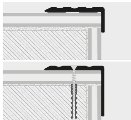
**PROSTEP INS** es un perfil para peldaños fabricado en aluminio anodizado plata. Ideal para colocar y proteger peldaños de madera, laminado y parquet. Disponibles en dos alturas: 10,2 y 15,9 mm.
