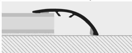
1. Choisir le ZERO CURVE adhésif de la finition désirée. 2. Couper le profilé à la longueur requise, dégraisser le plan et le sécher en s'assurant que la température de pose ne soit pas inférieure à 15°. 3. Enlever le papier de protection de l'adhésif et poser le profilé correctement en exerçant avec la main une pression verticale uniforme, sans bouger le profilé et sans utiliser de marteaux de fer/acier.
