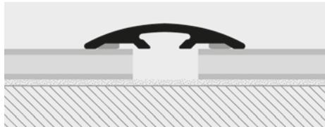
1. Choisir le SOL 30 adhésif de la finition désirée. 2. Couper le profilé à la longueur requise, dégraisser le plan et le sécher en s'assurant que la température de pose ne soit pas inférieure à 15°. 3. Enlever le papier de protection de l'adhésif et poser le profilé correctement en exerçant avec la main une pression verticale uniforme, sans bouger le profilé et sans utiliser de marteaux de fer/acier.
