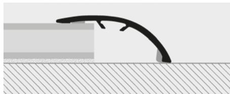
1. Scegliere il ZERO CURVE adesivo della finitura desiderata. 2. Tagliare il profilo alla lunghezza richiesta e pulire, sgrassare e asciugare il piano verificando che la temperatura di applicazione non sia inferiore a 15°. 3. Rimuovere la carta protettiva dell'adesivo e posare il profilo correttamente con una pressione verticale manuale uniforme senza muovere il profilo e senza l'utilizzo di martelli in ferro/acciaio.
