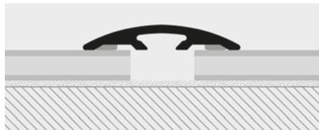
1. Scegliere il SOL 30 adesivo della finitura desiderata. 2. Tagliare il profilo alla lunghezza richiesta e pulire, sgrassare e asciugare il piano verificando che la temperatura di applicazione non sia inferiore a 15°. 3. Rimuovere la carta protettiva dell'adesivo e posare il profilo correttamente con una pressione verticale manuale uniforme senza muovere il profilo e senza l'utilizzo di martelli in ferro/acciaio.
