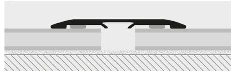
1. Elegir el perfil "SOL 40P" del ancho correspondiente a la junta entre los pavimentos teniendo en cuenta el apoyo lateral de 2/3 mm. 2. Rellenar la junta con silicona o el mismo adhesivo utilizado para la colocación del pavimento. 3. Presionar el perfil en el adhesivo, comprobando el apoyo sobre ambos los pavimentos.
