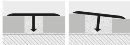
1. Elegir el perfil "PROCOVER WOOD" del ancho correspondiente a la junta entre los pavimentos teniendo en cuenta el apoyo lateral de 2/3 mm. 2. Rellenar la junta con silicona o el mismo adhesivo utilizado para la colocación del pavimento. 3. Presionar el perfil en el adhesivo, comprobando el apoyo sobre ambos los pavimentos.
