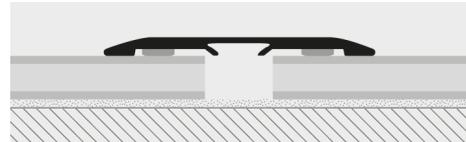
1. Choisir le SOL 40 adhésif de la finition désirée. 2. Couper le profilé à la longueur requise, dégraisser le plan et le sécher en s'assurant que la température de pose ne soit pas inférieure à 15°. 3. Enlever le papier de protection de l'adhésif et poser le profilé correctement en exerçant avec la main une pression verticale uniforme, sans bouger le profilé et sans utiliser de marteaux de fer/acier.
