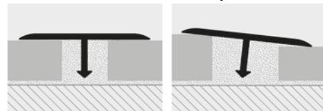
1. Choisir le "PROCOVER" d'une largeur correspondant au joint entre les deux revêtements à unir en tenant compte d'un appui latéral de 2/3 mm. 2. Remplir le joint de silicone monocomposant ou de la colle utilisée pour la pose du revêtement. 3. Enfoncer le profilé dans la colle en s'assurant qu'il soit bien appuyé des deux côtés sur les revêtements à unir.
