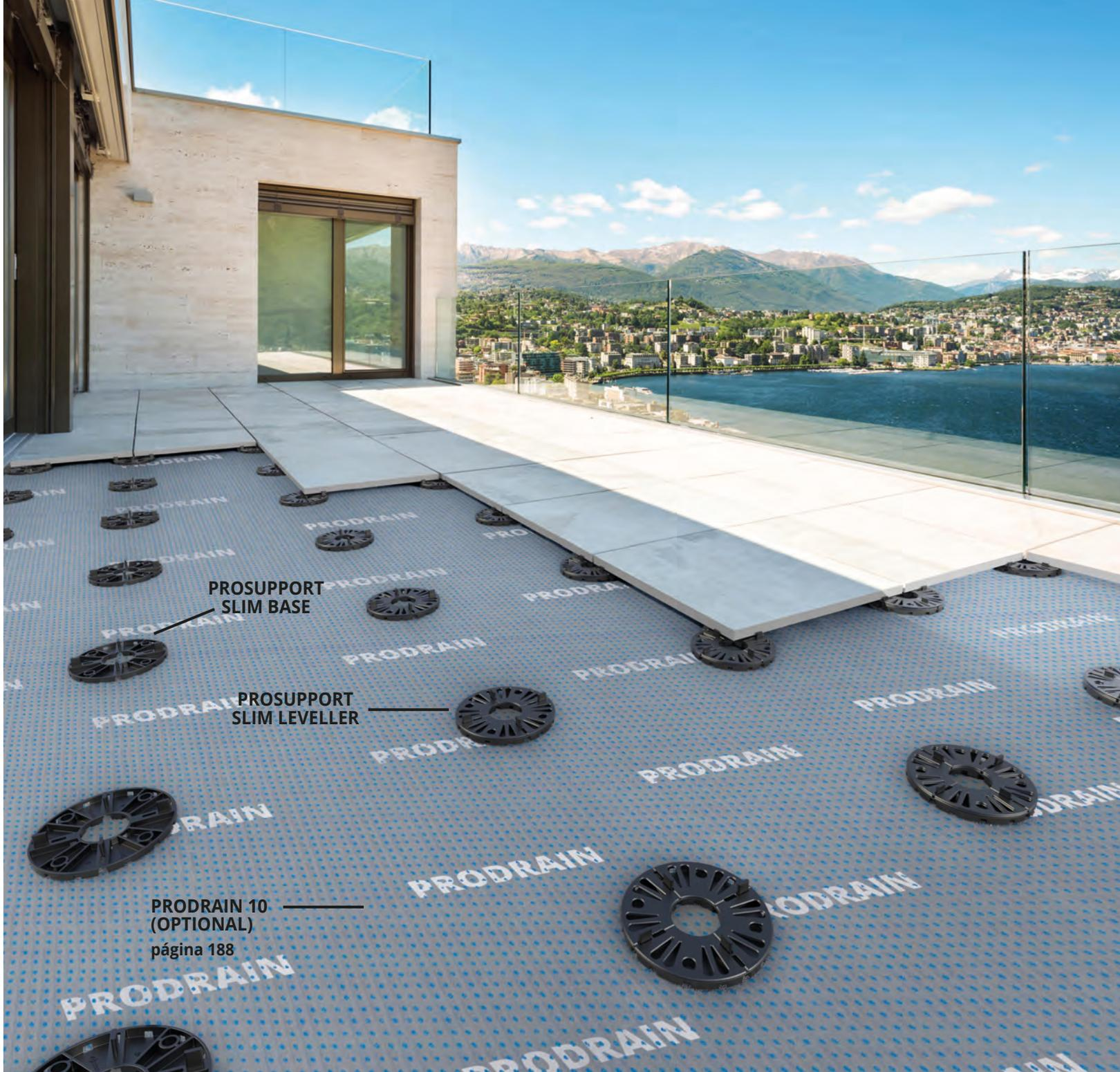
Los **SOPORTES** y **NIVELADORES** son idóneos para realizar suelos flotantes exteriores. Los soportes de polietileno tienen una altura de 15 mm. Los niveladores en goma de espesor 3 mm. se pueden colocar sobre los soporte en numero maximo de 2. Los soportes y niveladores son idóneos para areas exteriores, terrazas, bordes de piscinas y de tráfico peatonal.
