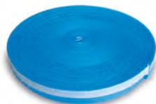
**PROECOFON** ist eine geschlossenzellige Polyäthylenrolle, die uLfm aufend zwischen Mauer und Estrich sowie bei den Dehnungsfugen zur Verwendung kommt. Ihre Verwendung ist empfehlenswert, um eine lange Lebensdauer des Bodens zu gewährleisten.
