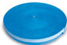
**PROECOFON** è un rotolo di polietilene a cella chiusa usato nel perimetro tra muro e massetto, e in coincidenza di giunti di dilatazione. È consigliabile usarlo in ogni lavoro di posa per garantire la durata del pavimento.
