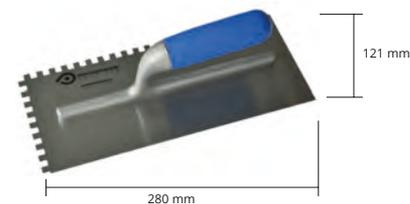
**TALOCHE** en tôle d'acier 10x10, support en aluminium poli avec fixation électro-soudée. Poignée en caoutchouc fixée avec un système sécurisé anti-rotation. Particulièrement indiqué pour la pose des carreaux au-dessus des systèmes d'étanchéité et isolants PRODESO® et PRODESO® HEAT & PRODESO® HEAT GRIP.
