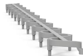
L'espaceur **RAPY 200** est solide, résistant et facile à poser. Adapté pour des structures installées horizontalement, verticalement et inclinées. Les trous latéraux et horizontaux permettent une parfaite pénétration dans le béton. Renversé peut être utilisé pour des panneaux isolants, pour des planchers et des structures préfabriquées. Sur demande disponible par 1 mètre.
