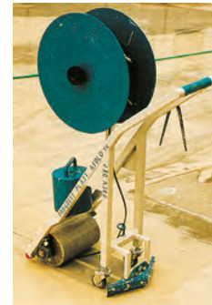
MÖRTELSCHLAMMSCHABER FÜR EINE GENAUERE VERLEGUNG
